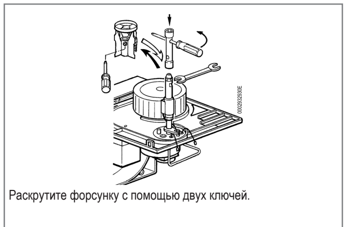
Чтобы демонтировать форсунку, следует снять вначале диск электродов, вывинчивая винт.
