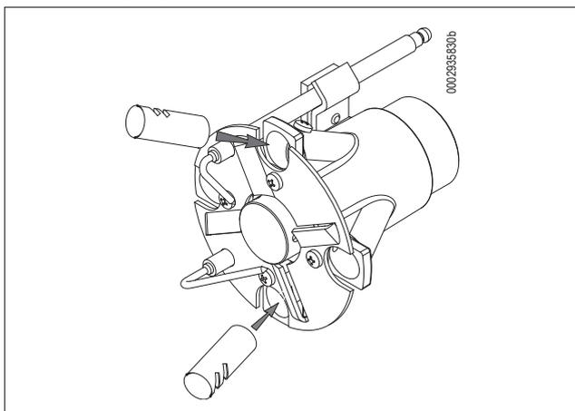
2) Вставить два редуктора В с отверстиями, направленными к внешней стороне смесителя
