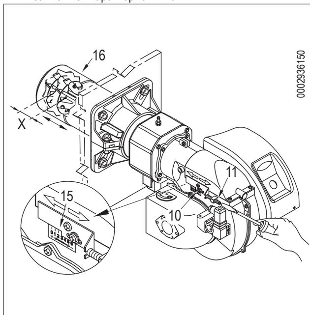
**СХЕМА РЕГУЛИРОВКИ РАССТОЯНИЯ ДИСКА ЭЛЕКТРОДОВ**
