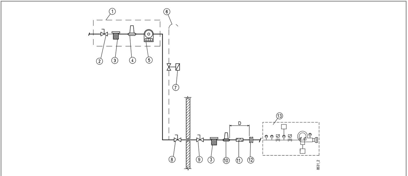
**ПРИНЦИПИАЛЬНАЯ СХЕМА ДЛЯ ПОДСОЕДИНЕНИЯ НЕСКОЛЬКИХ ГОРЕЛОК К ГАЗОВОЙ СЕТИ СРЕДНЕГО ДАВЛЕНИЯ**
