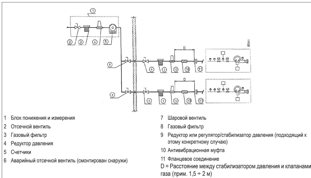
ПРИНЦИПИАЛЬНАЯ СХЕМА ДЛЯ ПОДСОЕДИНЕНИЯ НЕСКОЛЬКИХ ГОРЕЛОК К ГАЗОВОЙ СЕТИ СРЕДНЕГО ДАВЛЕНИЯ
